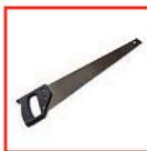
Ножовка для теплоизоляции
