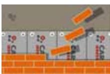
Возводят наружную часть стены из облицовочного кирпича или камня. Внутреннюю и наружную часть стены соединяют между собой гибкими стеклопластиковыми связями.
