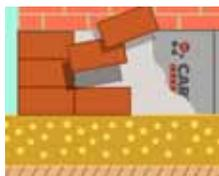
После всех операций производится обратная засыпка грунта. Выступающие плиты экструзионного пенополистирола в цокольной части покрывают декоративным защитным слоем: плиткой, камнем, либо сайдингом.
