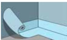
По периметру комнаты необходимо оклеить стены полосой из вспененного полиэтилена толщиной 8–10 мм. Полоса должна заходить с горизонтальной на вертикальную поверхность, выше финишной отделки.
