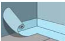
По периметру комнаты необходимо оклеить стены полосой из вспененного полиэтилена толщиной 8–10 мм. Полоса должна заходить с горизонтальной на вертикальную поверхность, выше финишной отделки.
