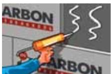
Прикрепить плиты XPS ТЕХНОНИКОЛЬ CARBON ECO FAS на стены при помощи клеевых составов, не содержащих растворителей (жидкие гвозди для пенополистирола, полимерно-цементные смеси). Клей следует наносить точечно, либо волнообразно.
