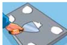
Нанесение клеевых составов может быть как точечным, так и полосами вдоль всей поверхности плит.
