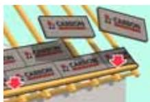
На стропила, установленные с шагом 0,6–1,2 м в нижней части кровли монтируется «стартовая планка» – брусок толщиной равной толщине слоя теплоизоляции. Это необходимо для того чтобы при монтаже плиты теплоизоляции не скатывались с крыши.
