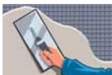
На зафиксированные плиты наносится слой штукатурки с армирующим слоем, и после высыхания производится финишная отделка (с приклейкой плитки, камня или нанесение декоративного слоя штукатурки).
