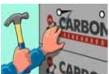
После приклеивания плиты рекомендуется дополнительно закрепить механически. Для этого используют дюбели из расчета 4–5 шт. на м<sup>2</sup>. В угловых частях здания и по периметру проемов количество дюбелей увеличивают до 8 шт. на м<sup>2</sup>.
