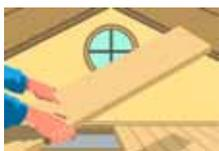
Принимаем, что деревянный настил уже имеется на объекте. Перед монтажом теплоизоляции убеждаемся, что основание ровное, пригодное для укладки плит.
