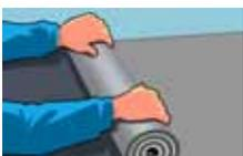
Производится укладка геотекстильного полотна 300–500 г/м<sup>2</sup>, которое дополнительно снижает уровень ударного шума.
