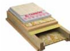
Данная система состоит из экструзионного пенополистирола ТЕХНОНИКОЛЬ CARBON ECO, пароизоляционного слоя, а также распределяющего слоя. Экструзионный пенополистирол можно укладывать как между балками перекрытия, так и на черновой пол. Слой пароизоляции укладывают как правило в случае устройства пола над холодным подвалом.
