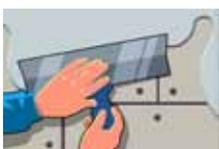
После установки листов гипсокартона (ГВЛ, СМЛ и др.), стыки плит и шляпки саморезов нужно зашпатлевать, поверхность листов оштукатурить и выполнить финишную отделку (облицовка керамической плиткой, нанесение слоя декоративной штукатурки, либо грунтовка специальными составами и приклеивание обоев).
