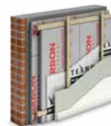
Пленка дополнительно прижимается рейками, по которым выполняется внутренняя отделка помещения. Образовавшийся зазор между пароизоляцией и внутренней отделкой необходим для прокладки коммуникаций (электрика, отопление, водоснабжение) без нарушения пароизоляции.
