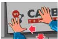
После нанесения клеевого раствора плиту прикладывают к месту установки с небольшим смещением, и затем с надавливанием сдвигают до места установки. Таким образом клеевой состав равномерно распределяется под соприкасаемыми поверхностями, делая сцепление плиты со стеной более прочным.
