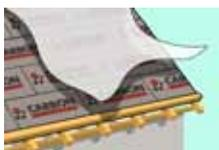
При необходимости в конструкции кровли следует предусмотреть слой пароизоляции, укладываемой как сверху, так и снизу плит теплоизоляции.
