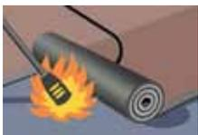
На железобетонное основание крыши укладывается (наплавляется или наклеивается) гидроизоляционный ковер.
